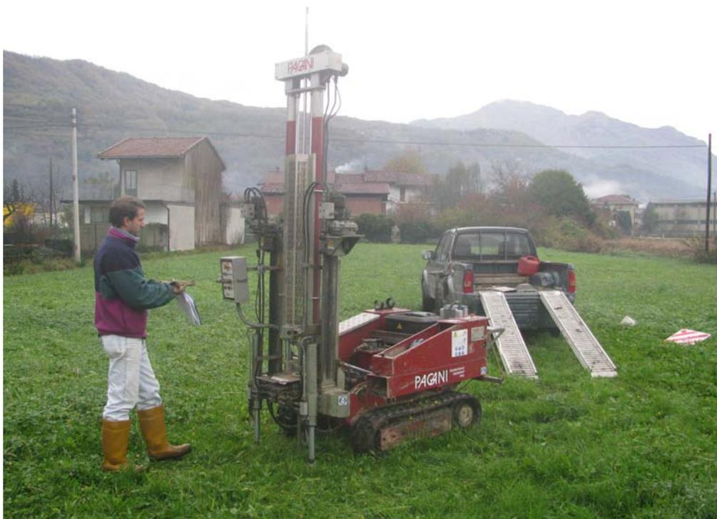
Foto 1 e 2 : Terreno interessato dalle opere in progetto e attrezzatura utilizzata per l'esecuzione delle prove penetrometriche
